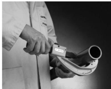
Отрезание трубы необходимой длины
